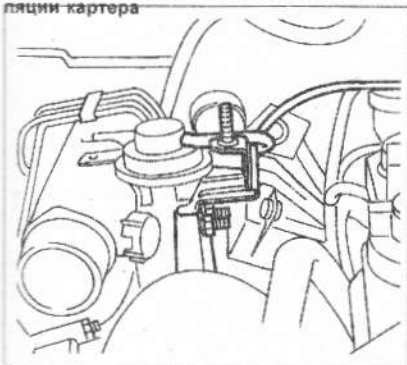
5.132 Отсоедините шланг от клапана рециркуляции ОГ, отвинтите две гайки и снимите кронштейн
