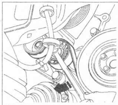
4.37 Натяните ручейковый ремень, повернув ролик автоматического натяжения ремня за центральный болт накладным ключом по часовой стрелке
