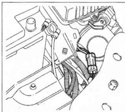
5.3 Отсоедините штекер вентилятора
