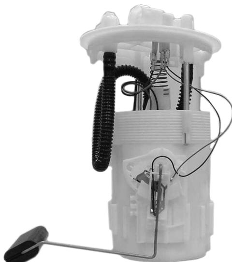
La pompa elettrica carburante ha la funzione di alimentare la pompa ad alta pressione. Essa si trova completamente immersa nel carburante all'interno del serbatoio. Il gruppo pompa è realizzato in modo da ottenere il massimo livello di carburante nella zona di pescaggio. Questa funzione viene realizzata per mezzo di un venturi posto sul tubo di ritorno al pescaggio rispetto a quello del serbatoio. Il gruppo pompante è del tipo a rullini e consente una portata di 160 litri/ora.
