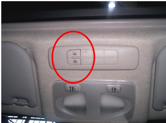
motorino elettrico e centralina tetto apribile (integrati)
