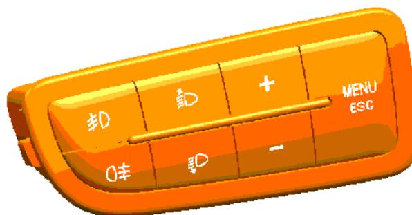
La Plancetta comandi sinistra ELC è un modulo che integra i comandi sul lato esterno del volante e si interfaccia al Nodo body computer BCM e al Nodo quadro strumento IPC tramite l' Insieme cavi plancia.
