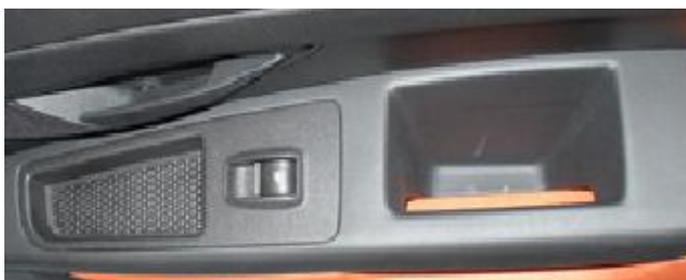
Il Comando alzacristallo su porta anteriore lato passeggero si collega tramite l'Insieme cavi porta anteriore lato passeggero per fornire il comando al relativo motore alzacristallo e riceve l'alimentazione per illuminazione ideogramma e per il corretto funzionamento del comando stesso.
