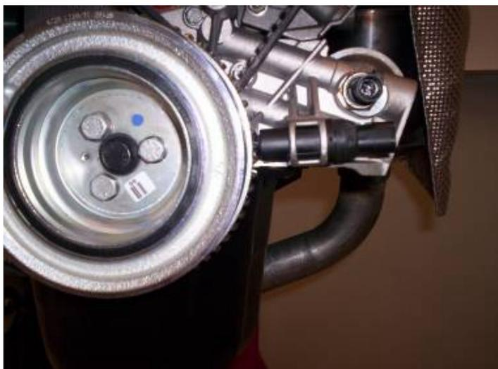
*La sede del sensore giri motore non ha regolazioni, quindi non ci sono problemi per il montaggio del sensore*
