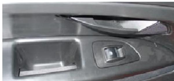
Il Comando su porta posteriore lato sinistro e lato destro RDC si collega tramite l' Insieme cavi su porta posteriore ed e' acquisito da una elettronica posta all' interno del motorino alzacrystallo su porta posteriore, con funzione di automatismo sia in salita che in discesa con protezione antipizzicamento.
