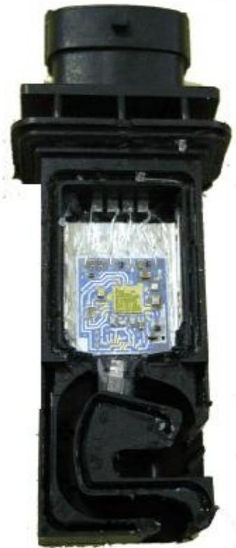
La variazione dei valori resistivi viene convertita da analogica a logica grazie ad un "Convertitore Analogico Digitale" (3). Il dato ottenuto viene memorizzato in una memoria dati
