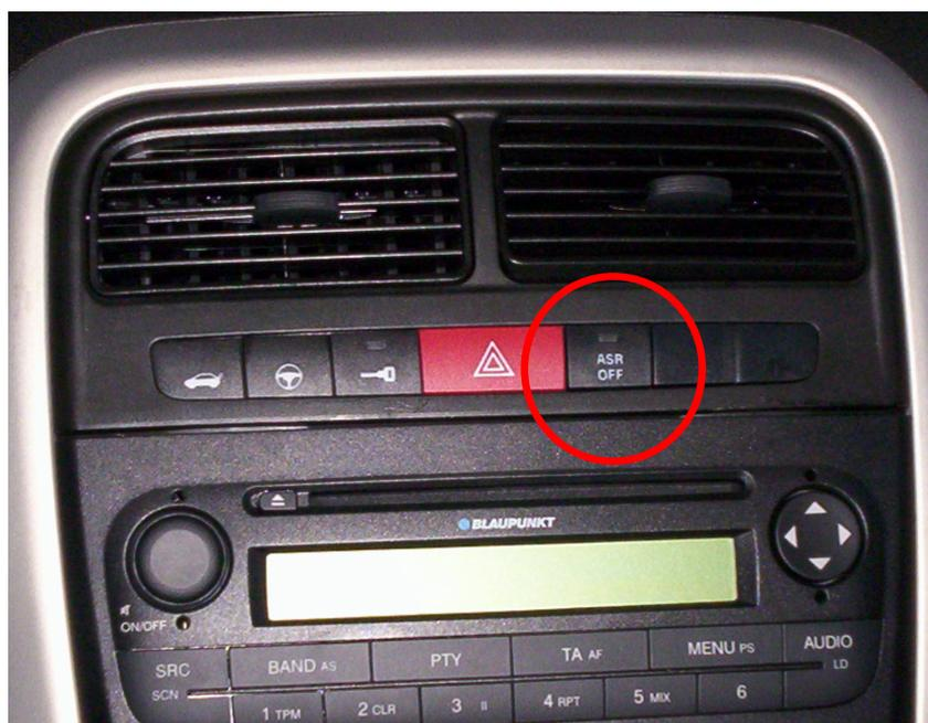
Viaggiando su fondo innevato, con le catene da neve montate, può essere utile disinserire l'ASR: in queste condizioni infatti lo slittamento delle ruote motrici in fase di spunto permette di ottenere una maggiore trazione.
