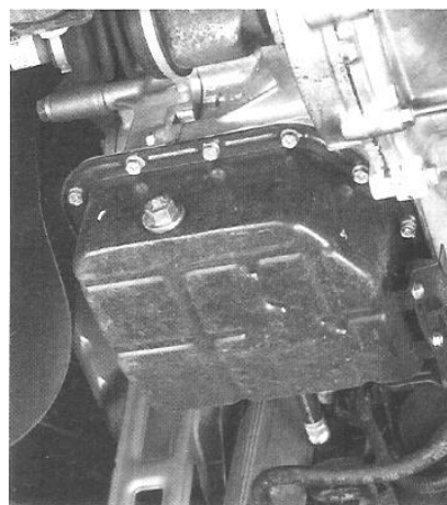
Rys. 4.1. Korek spustowy oleju w automatycznej skrzynce przekładniowej ECVT
