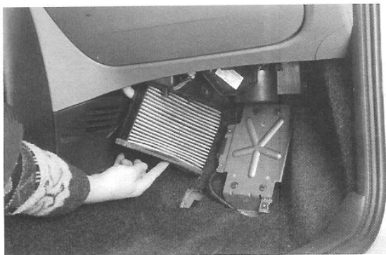
Rys. 11.1. Wymiana filtra powietrza w układzie przewietrzania
