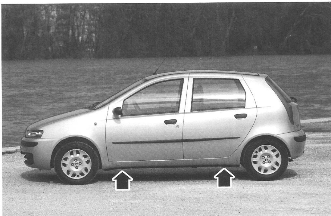
Rys. 0.5. Miejsca podparcia samochodu podnośnikiem z jego wyposażenia
