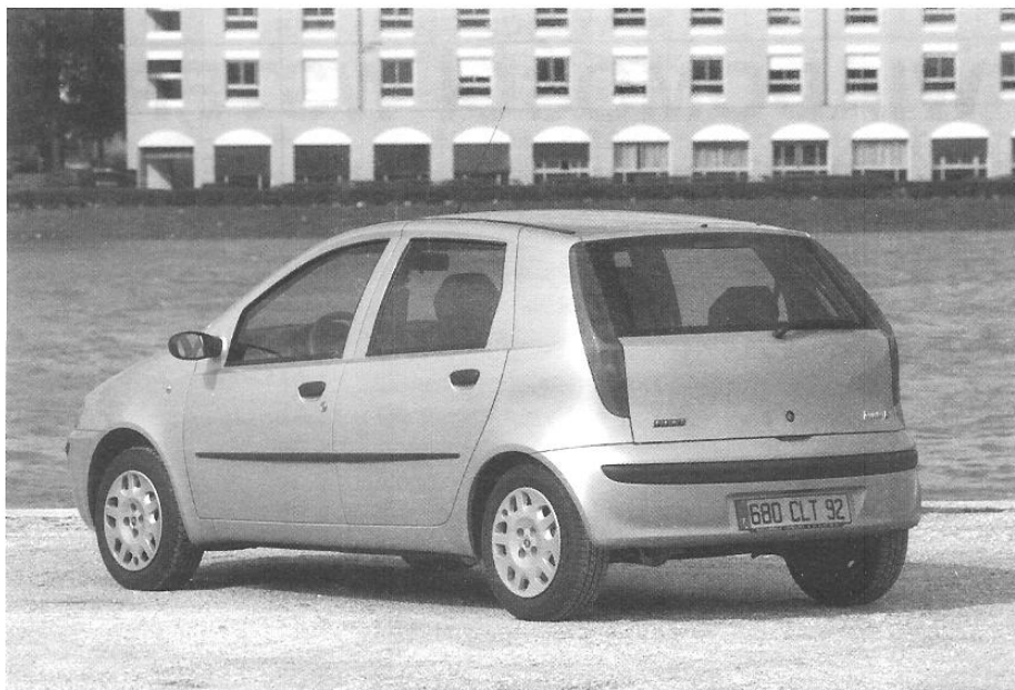
Rys. 0.2. Tyłne lampy usytuowano tak, aby zwiększyć pojemność bagażnika
