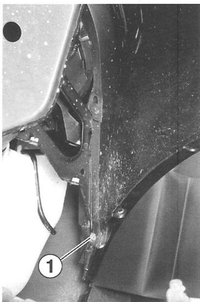
Rys. 11.15. Wymontowanie zderzaka przedniego – pierwsza czynność
