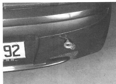
Rys. 0.7. Miejsce wkręcenia we wnęce tylnego zderzaka zaczepu do holowania samochodu
